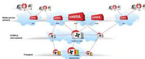
ภาพแสดงตัวอย่างระบบกระจายสัญญาณวิดีโอผ่านใยแก้วนำแสง (Equipment for video over fiber network)
