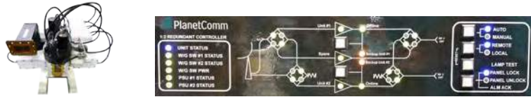
ภาพแสดงอุปกรณ์ควบคุมการส่งการทำงานของภาครับสัญญาณดาวเทียม (Redundant Controller 1:1LNx)
